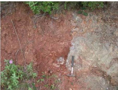
Fig. 22 – Transição entre material piroclástico grosseiro, à direita, e argilas vermelhas, à esquerda, as quais marcam o topo do Complexo vulcano-sedimentar (martelo como escala).
