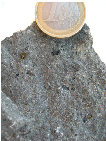
Fig. 3.24 – Aspecto de um fragmento de uma intrusão de dolerito do Complexo vulcano-sedimentar, evidenciando uma textura entre o gabro e o basalto e alguns cristais macroscópicos de olivina, de piroxenas e de hornblenda (vertente norte da RP; martelo e moeda como escalas).
