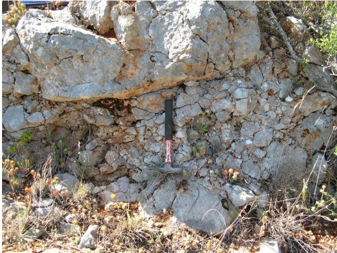
Fig. 3.31 – Aspecto brechóide de uma bancada carbonatada in situ com estratificação N55°,18°NO (sector central da RP junto à escarpa sul; martelo como escala).
