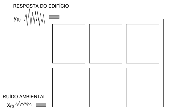
FIGURA 36 - Esquema da medição in situ das características dinâmicas dos edifícios.
