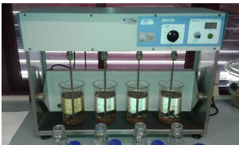
Figura 3-1: Unidade de Jar-test utilizada nos ensaios de C/F/S
