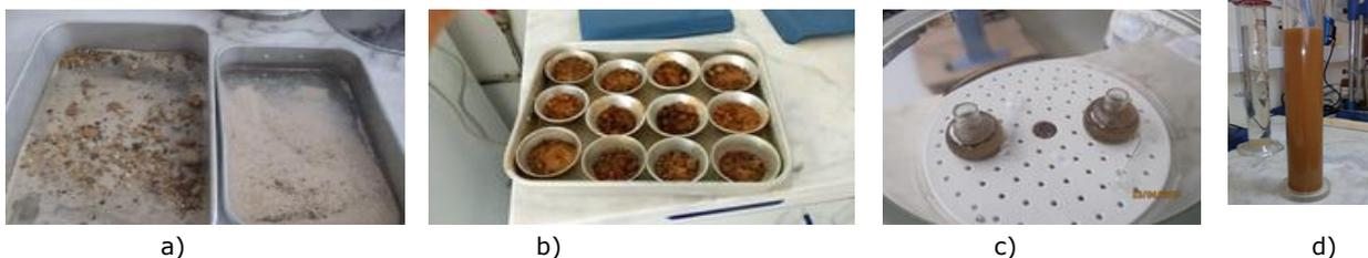
Figura 3 – a) Determinação das partículas sólidas; b) Determinação da percentagem de matéria orgânica no solo do litoral Algarvio; c) Análise granulométrica por peneiração húmida; d) Ensaio de Sedimentação
