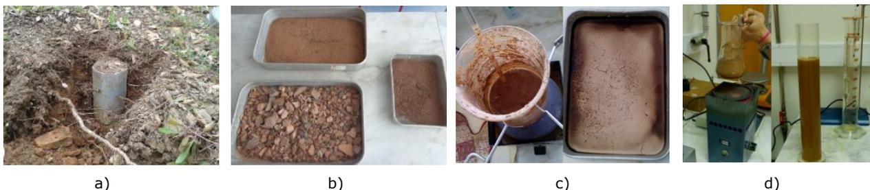
Figura 8 – a) Local onde foi recolhido o solo da Serra Algarvia; b) Peneiração do solo: separação do material no peneiro de 2mm; c) Pré-tratamento da amostra devido à quantidade de matéria orgânica; d) Ensaio de sedimentação
