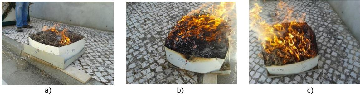
Figura 4 – a) Ensaio de combustão na amostra B<sub>LA</sub> (MB=1kg); b) Amostra C<sub>LA</sub> (MC=2kg); c) Amostra D<sub>LA</sub> (MD=4kg)
