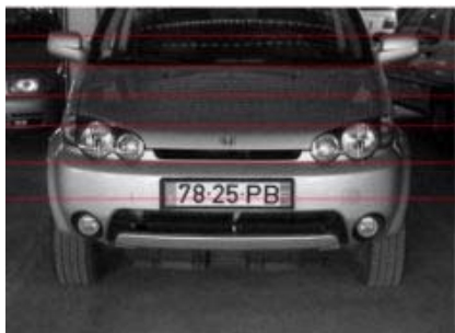
Fig. 2 – Intercepção da linha que percorre a imagem com a matrícula.
