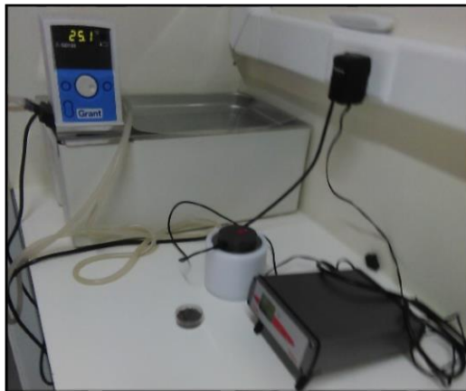
Figura 2.8 - Medidor de atividade de água (ROTRONIC HYGROLAB) utilizado na determinação de atividade da água em amostras da cavala ( Scomber spp ) e do carapau ( Trachurus spp ) processadas em Faro.
