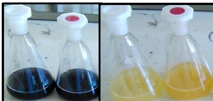
Figura 2.14 - Processo utilizado para determinação dos peróxidos nas amostras de peixe antes e depois da titulação pelo método iodométrico.
