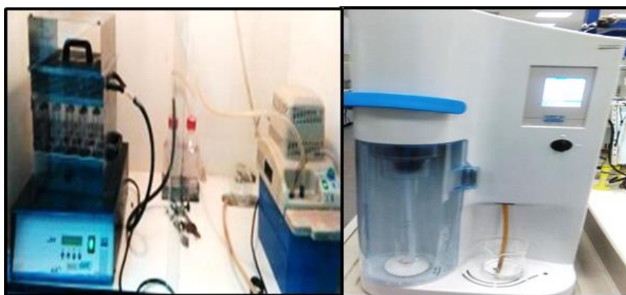
Figura 2.5 - Digestor automático de Kjeldahl (Auto-Analyzer 1035), e Destilador automático de Kjeldahl (AutoAnalyzer 1035) utilizados na quantificação de proteínas de peixe.
