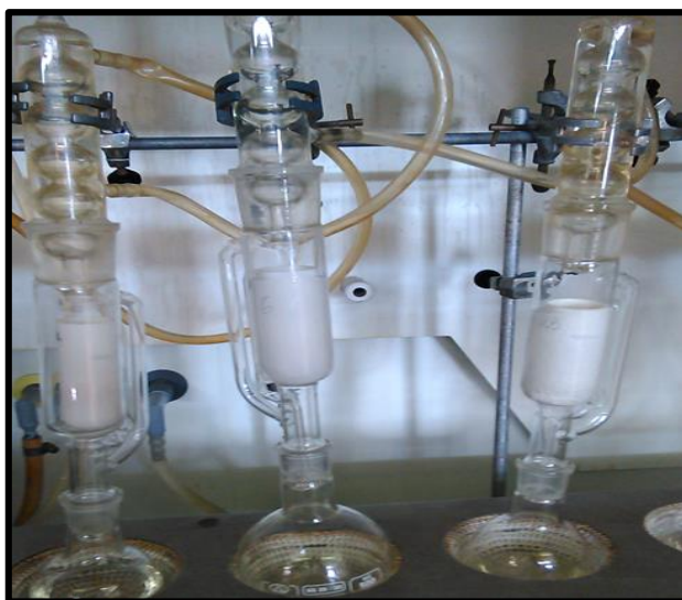
Figura 2.6 - Processo de extração contínua de gordura de peixe pelo método de Soxhleht (extração a quente).
