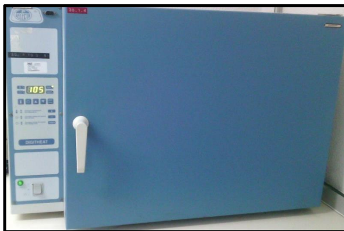
Figura 2.4 - Estufa (DIGITHAT) utilizada na secagem da humidade
