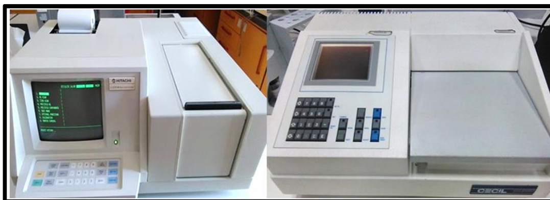
Figura 2.15 - Espectrofotômetros U-2000 HITACHI e CECIL 2000 Series utilizados na leitura de absorvência de amostras da cavala ( Scomber spp ) e carapau ( Trachurus spp ) processadas em Faro e em Luanda, respetivamente.
