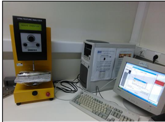
Figura 2.10 - Imagem da instalação do texturómetro (LFRA 1500, Brookfield, EUA) utilizado para avaliar a textura (dureza) nas amostras de cavala ( Scomber spp. ) e carapau ( Trachurus spp. ) processadas em Faro.
