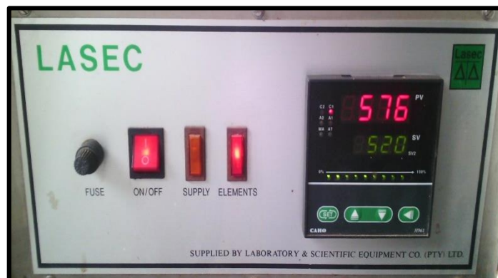
Figura 2.7 - Mufla (LASEC LABAROTORY & SCIENTIFIC EQUIPAMENT) utilizada para na determinação do teor em cinza.
