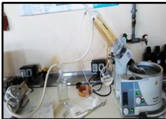
Figura 2.13 - Roto vapor utilizado para evaporação do éter de petróleo e de clorofórmio no processo de extração de gordura do peixe.
