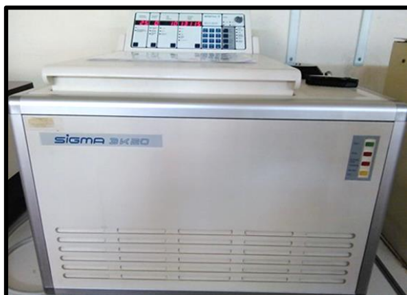
Figura 2.11 - Centrífuga (SIGMA 3K 20) utilizado para a determinação de capacidade de retenção de água (CRA) nas amostras de cavala ( Scomber spp ) e de carapau ( Trachurus spp ) processadas em faro.
