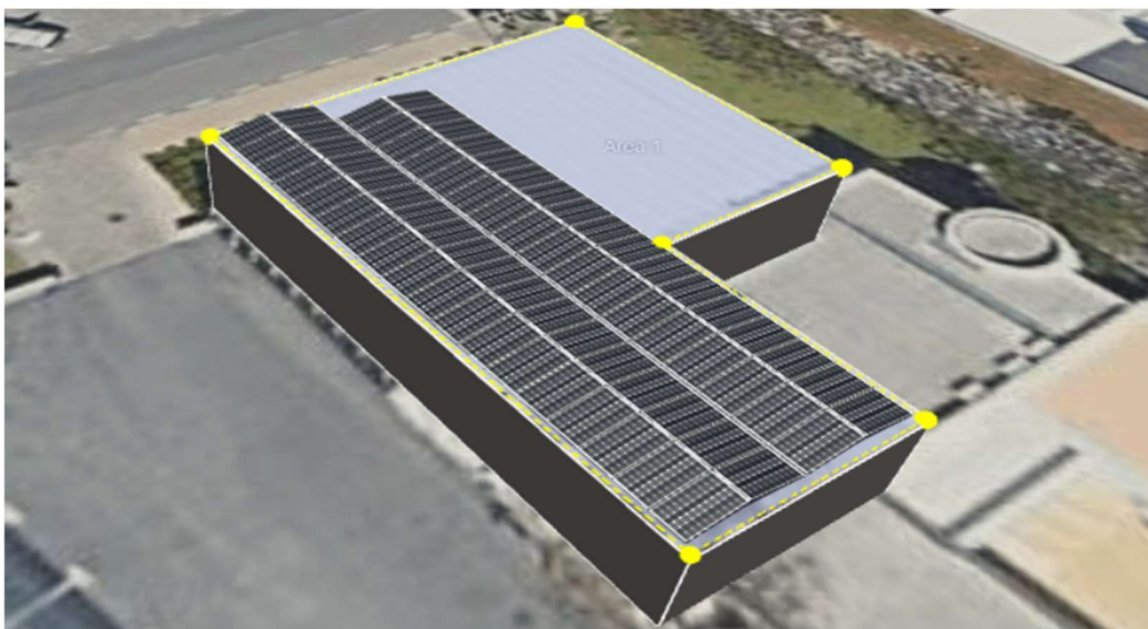
Figura 9 - Painéis fotovoltaicos simulados pelo SunnyDesign.
