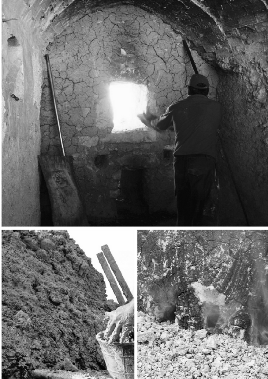
Figura 3 – Forno de cal de Caleras de la Sierra em processo de cozedura, na primeira imagem com o trabalhador a alimentar o forno; na segunda a preparar o revestimento de barro; por último onde se vê o fumo a sair pelos orifícios de respiração ao redor da cobertura, durante a laboração.
