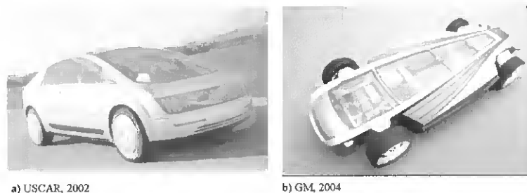
Figura 5.1 - a) GM Hy-wire - Automóvel eléctrico com tecnologia de pilha de combustível. b) Chassis do GM Hy-wire, onde se encontram todos componentes do sistema de propulsão do automóvel.
