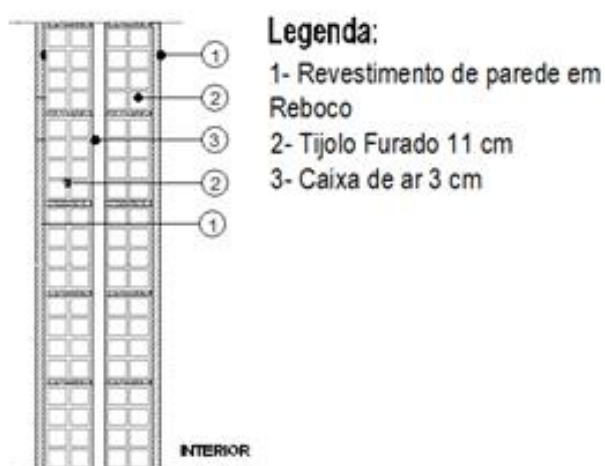
Figura 3.15- Envoltente exterior da construção tradicional
