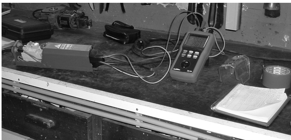
Figura 5.8: Fotografias da instalação utilizada em laboratório para medir os parâmetros eléctricos duma luminária nova.
