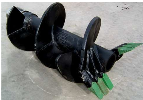
Fig.4 – Trado contínuo oco (imagem retirada de http://www.metalsintra.pt/trado-contínuo-p26 , em Fevereiro de 2015)
