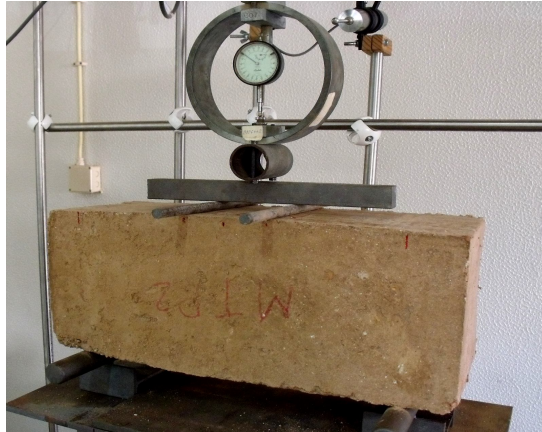
Fig. 5 – Ensayo de tracción por flexión de un bloque de tierra. (Créditos: Braga, 2011)
