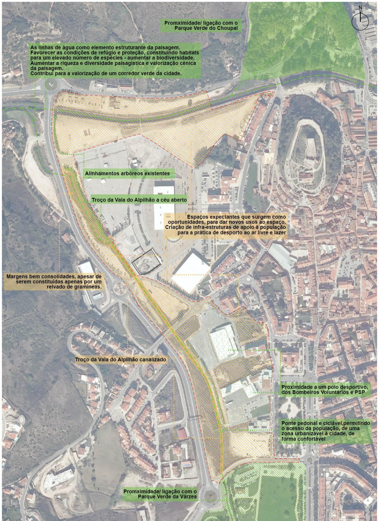
Figura 4.31. Diagnóstico da área de intervenção e área envolvente (zona da Vala do Alpilhão). Pontos Fortes e Potencialidades (a verde), Pontos Fracos e Constrangimentos (a laranja). Escala 1: 5000.
