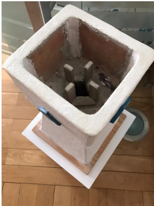
Figura 7 - Pormenor do sistema interior da chaminé de balão. Fotografia cedida por Miguel R. Costa.
