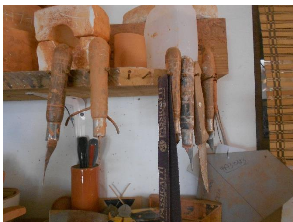
Figura 4 - Exemplos das facas usadas para fazer os recortes nas chaminés. Fotografia da autora.
