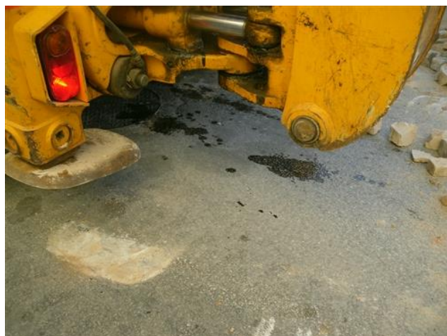
Figura 4.139 – Fuga de óleo
