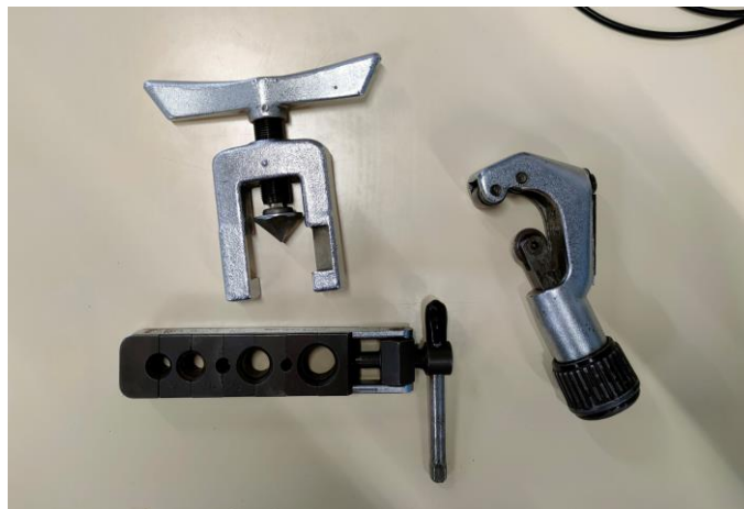
Figura 3.17 - Equipamentos para corte, escareamento e abocardamento dos tubos de cobre
