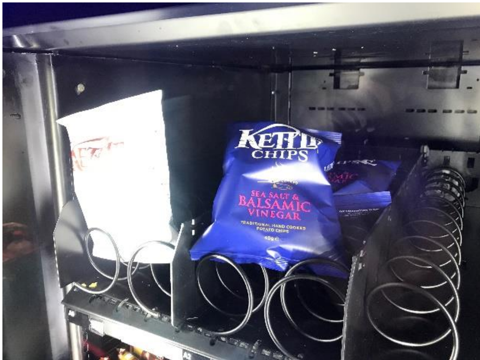
Figura 6.21. Problemas com a máquina de venda: Produto mal colocado no dispensador e bloqueado para venda. Fonte: do autor (2018).
