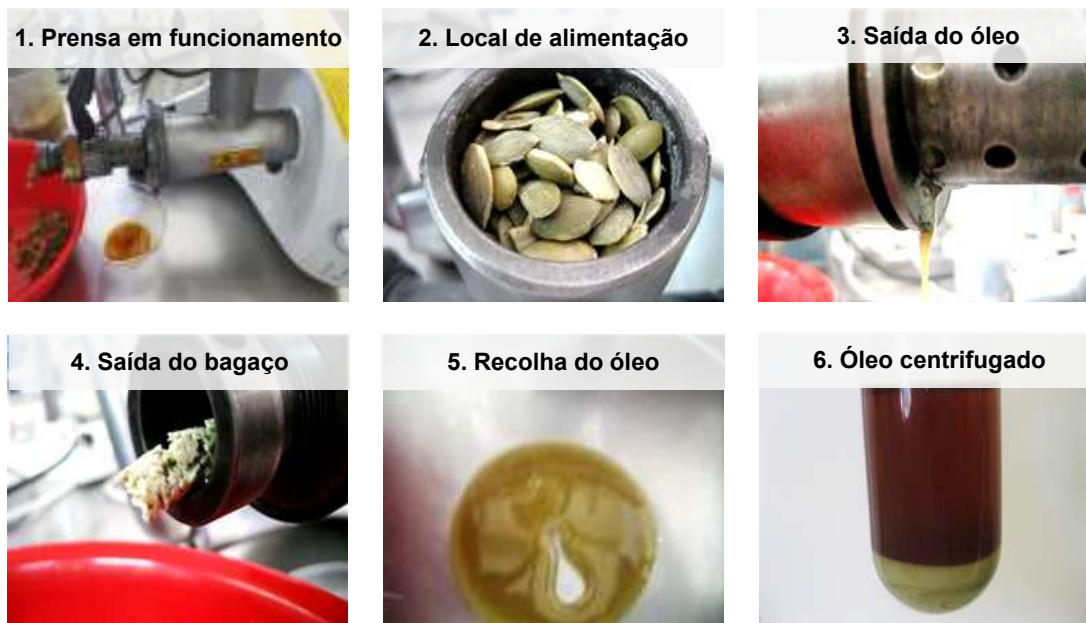
Figura 2.2 - Principais etapas da extração do óleo, utilizando a prensa (©Vanessa Sousa, 2012).
