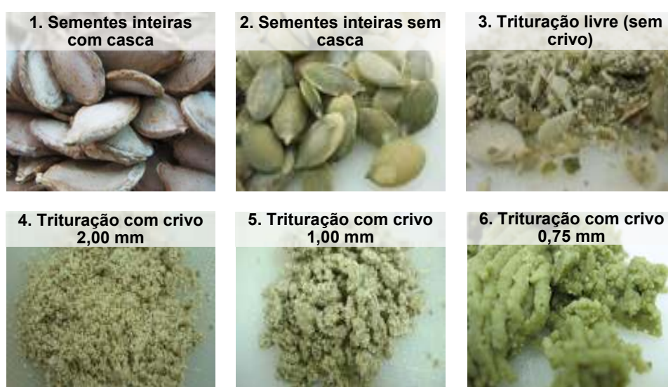
Figura 3.1 - Diferentes fases da redução de dimensões no moinho de martelos, utilizando sementes de abóbora (©Vanessa Sousa, 2012).
