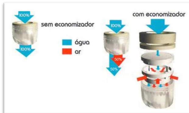
Figura 4 – Funcionamento de um redutor de caudal (Ecocasa, 2010)
