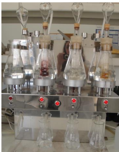
Figura 2.13: Cazenave-Ferré utilizado para determinação da acidez volátil.
