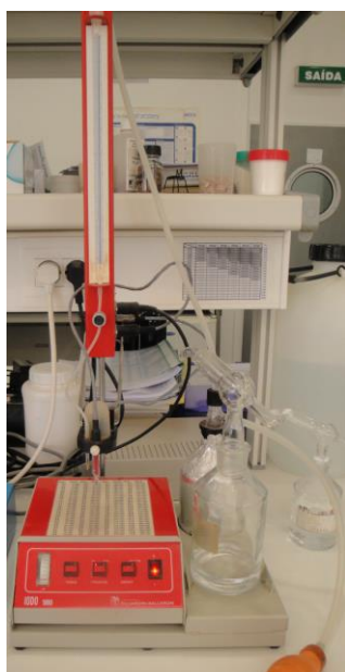
Figura 2.15: Doseamento do SO 2 livre pelo Iodomatic.
