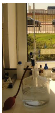
Figura 2.14: Determinação da acidez total por titulação com NaOH 0.1M.
