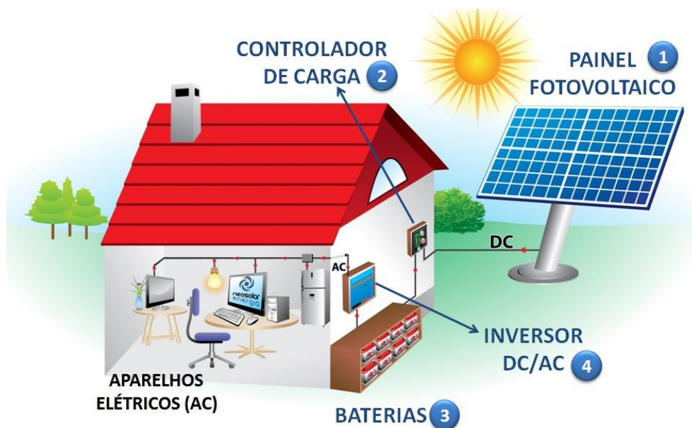
Figura 4.1 - Energia solar fotovoltaica: Princípio de funcionamento [44]
