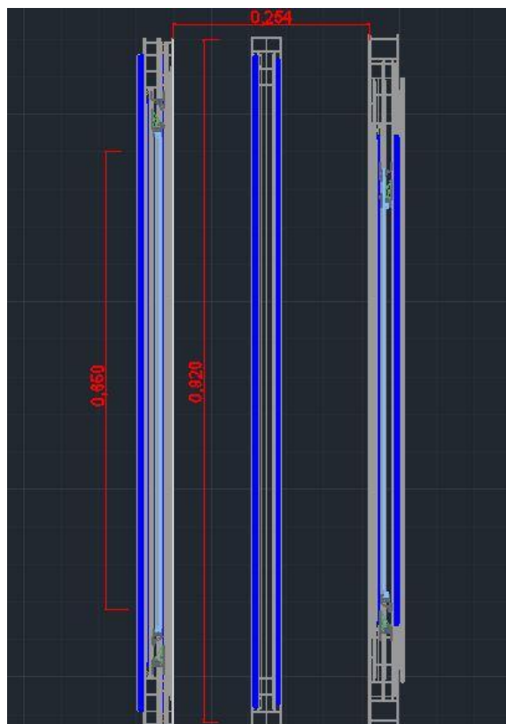
Figura 7 – Modelo geral para os dois casos de estudo com dimensões (m) de vidro e caixa de lamelas (altura e largura)
