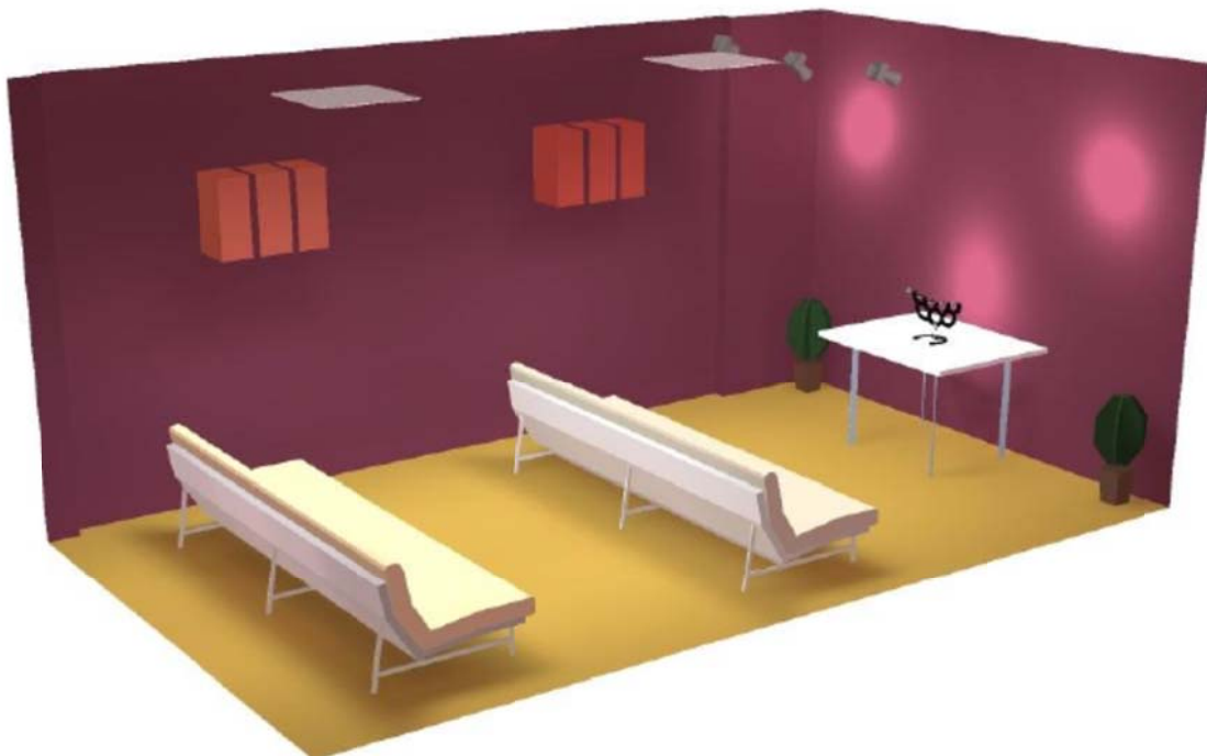
Figura 3-6 – simulação do cálculo luminotécnico: representação espacial em 3D no programa “Dialux”.
