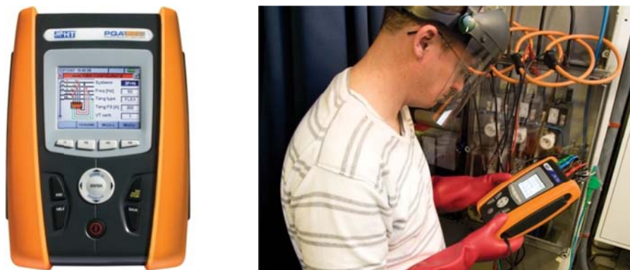
Figura 4-2 – Analisador de redes PQA 824 da HT e Técnico a utilizar o equipamento.
