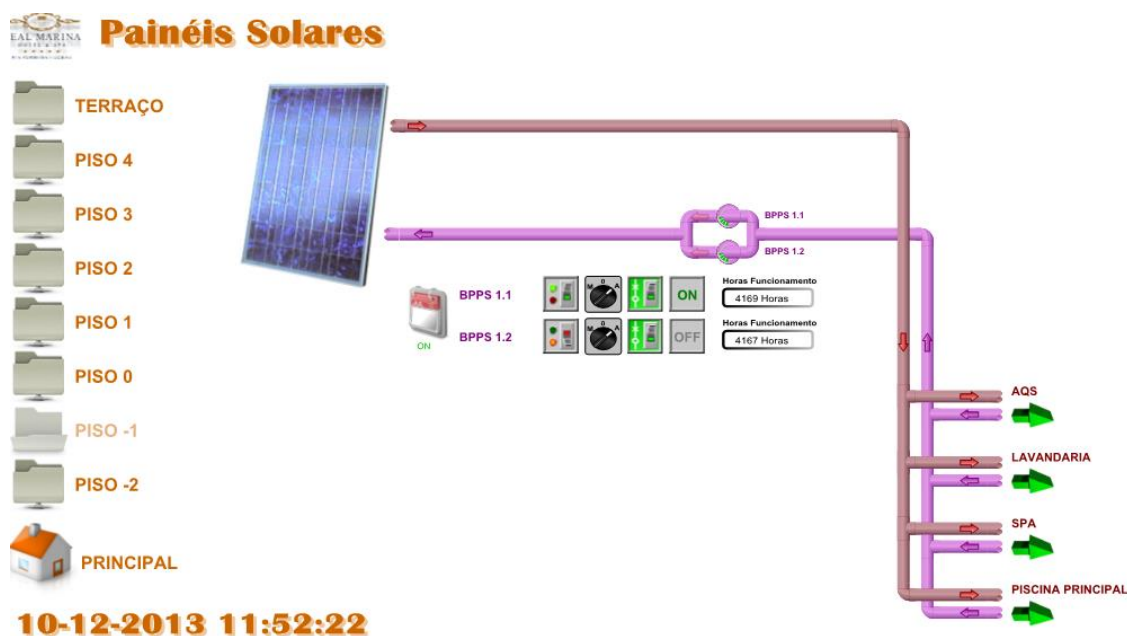
Figura 3.8 - Central Térmica utilizando os painéis solares (RMH, 2014)
