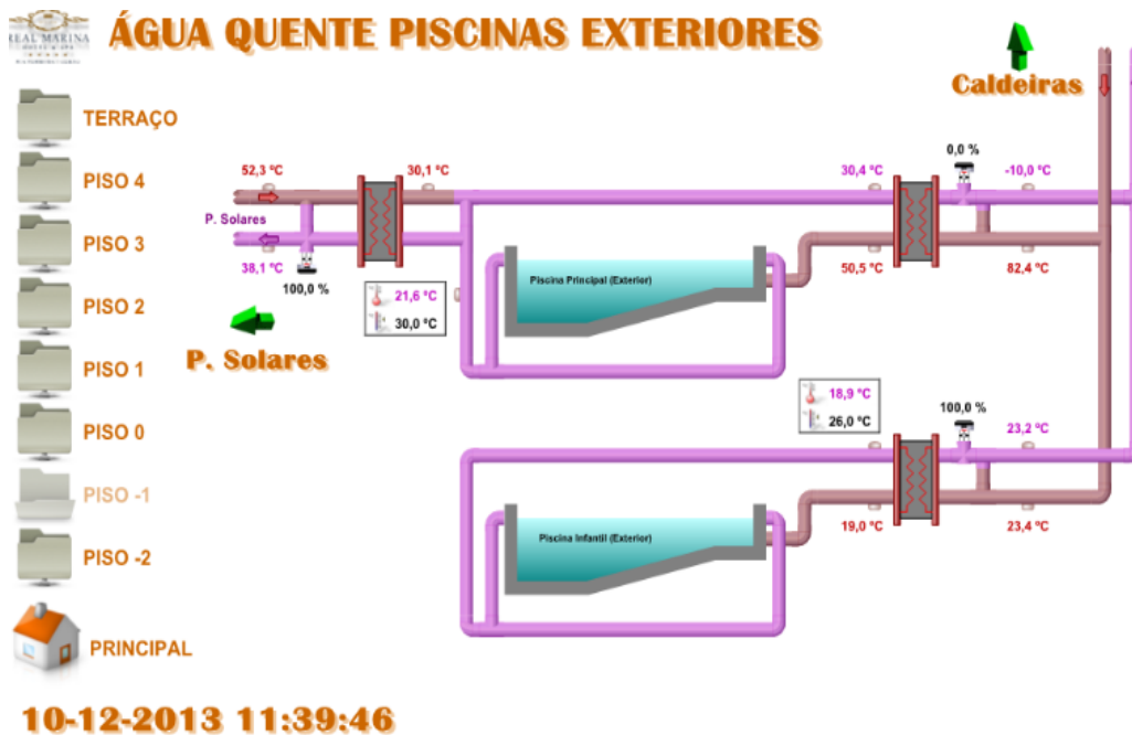
Figura 3.24 - Circuito de água quente das Piscinas exteriores (RMH, 2014)
