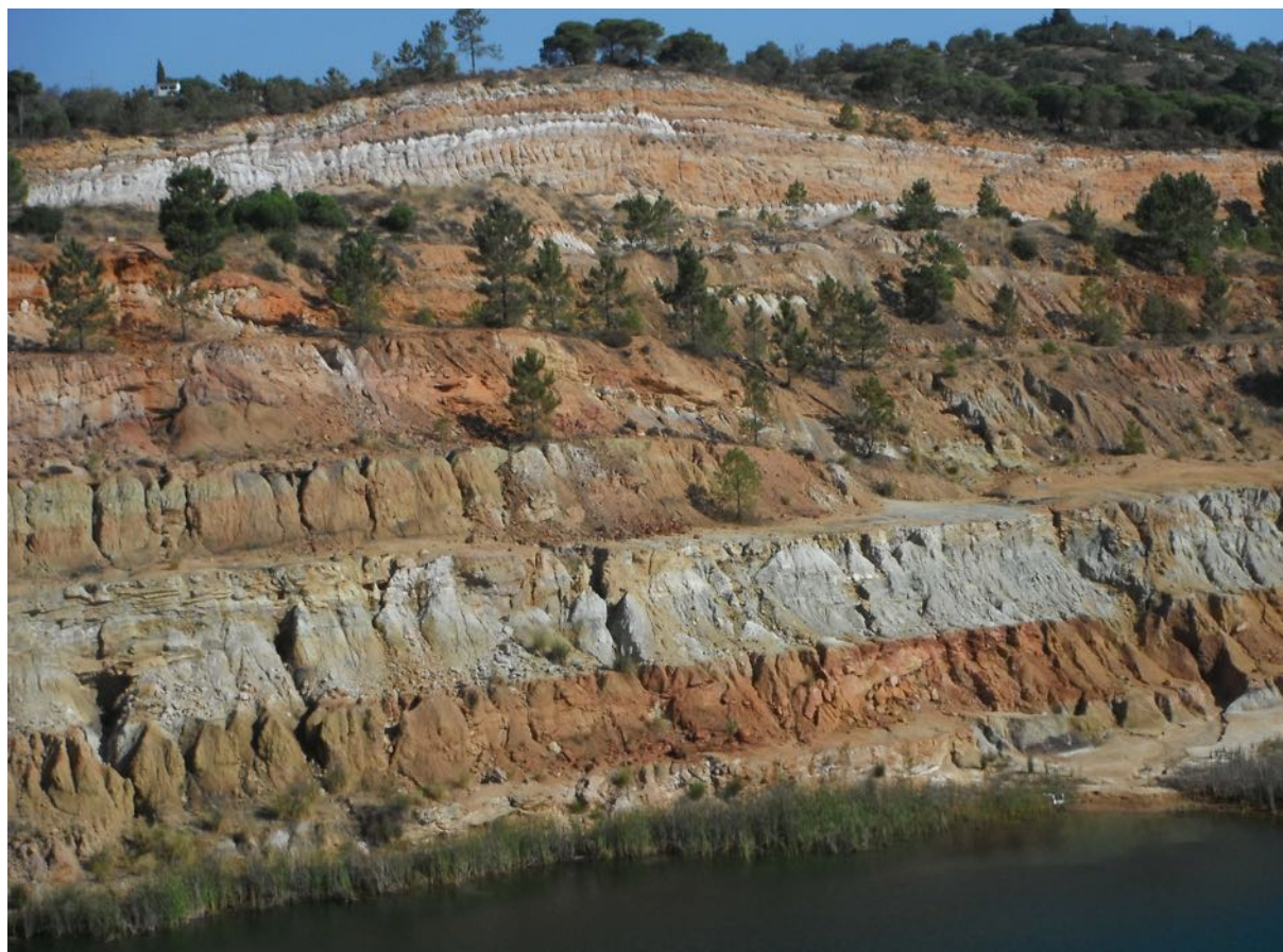
Figura 5.5. Sequência sedimentar das argilas do Cretácico, em Mem Moniz, numa das paredes de exploração da Fábrica de Cerâmica do Algarve (FACEAL).
