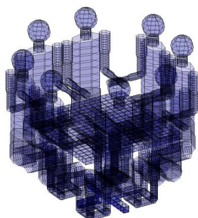
Figura 5.8: Malha de uma só mesa ocupada por 8 idosos usado no modelo HTC.
