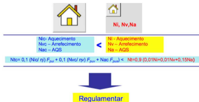
Fig. 2.72 – Verificação regulamentar dos requisitos energéticos pelo RCCTE [3]
