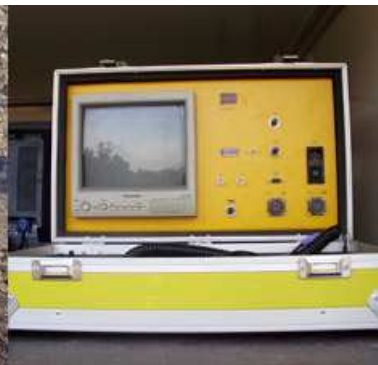
Figura 2.11 – Equipamentos utilizados para inspeção vídeo de coletores de drenagem de águas residuais e pluviais.
