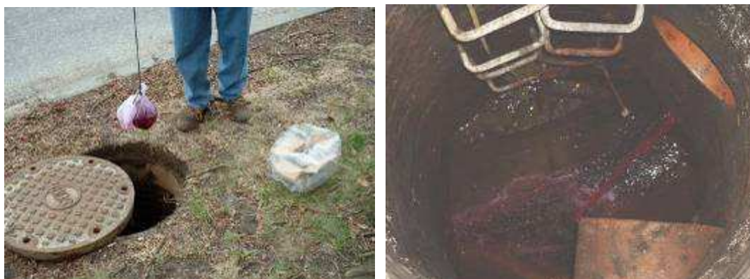
Figura 2.15 - Introdução de traçador químico numa câmara de visita de montante (esquerda) e observação na câmara de jusante (direita) (Administração da Região Hidrográfica do Tejo, 2010).
