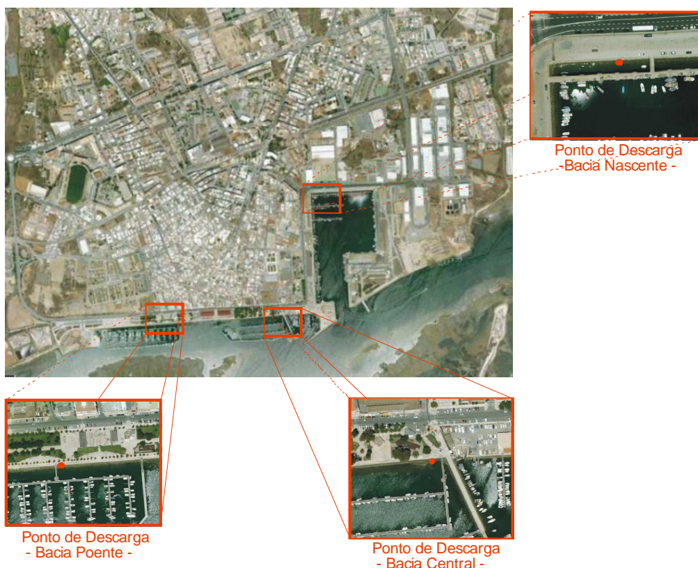
Figura 3.3 - Localização dos pontos de descarga das bacias de drenagem de águas pluviais da cidade de Olhão.
