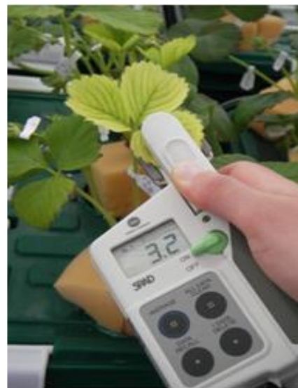
Figura 2.5: Aparelho de SPAD.
