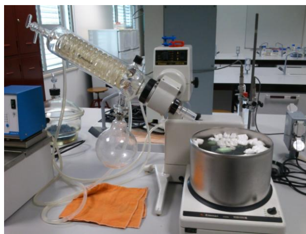
Figura 17 - Evaporador rotativo Heidolph 94200 – Biolock Scientific
