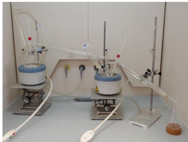
Figura 21 – Esquema de montagem do sistema de destilação a vapor.
