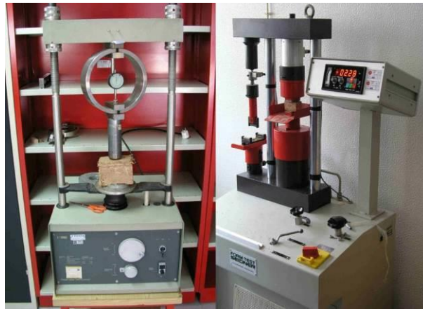
Fig.1 - Equipamentos utilizados, maquina de CBR Triaxial-tester T4010 Electronic e maquina de ensaio de argamassas Form+Test Seidner, tipo 505/200/10DM. (Bexiga 2007: 117). Fotos do autor
