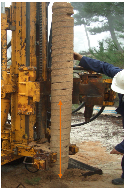
Figura 17: Trado com solo (seta vertical representa os 30 cm onde se colheu amostras no trado ao longo dos 900 cm de sondagem)
