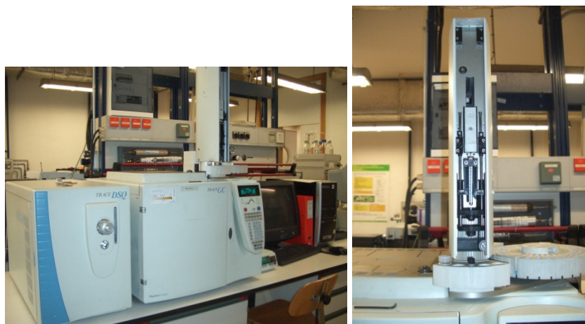
Figura 6: Cromatógrafo gasoso Trace GC acoplado a um espectrômetro de massa Trace DSQ da ThermoFinnigan e respectivo amostrador automático
