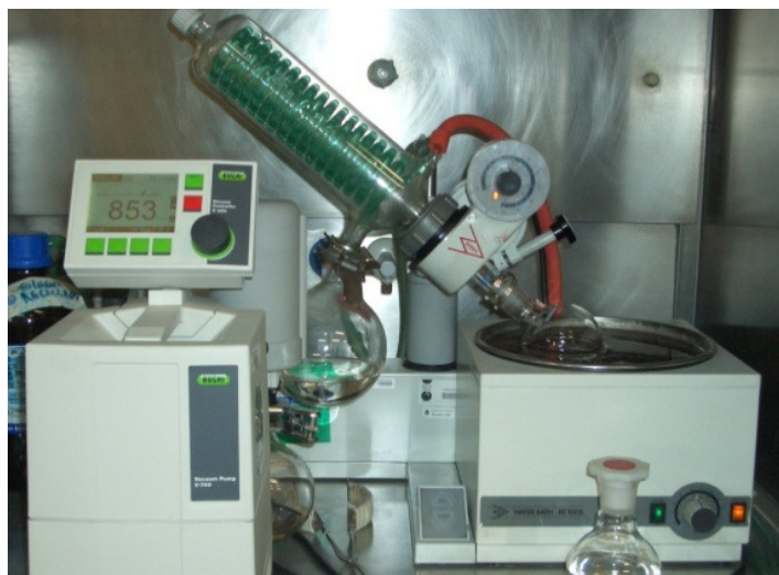
Figura 11: Evaporação do acetonitrilo no evaporador rotativo
