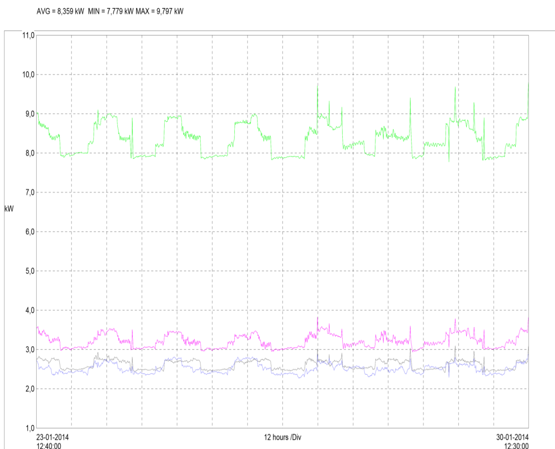
Gráfico 4.2 – Medições elétricas dos equipamentos da central térmica.
