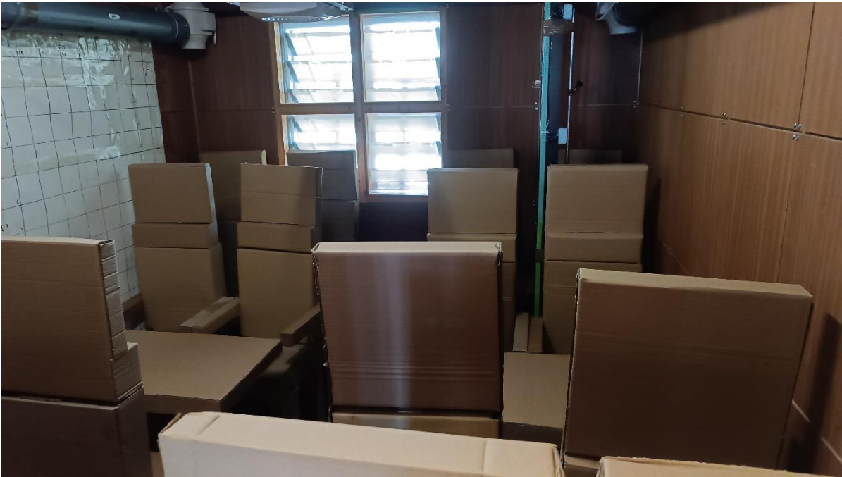
Figura 20 fotografia da câmara climática, obstáculos internos montados e posicionados.
