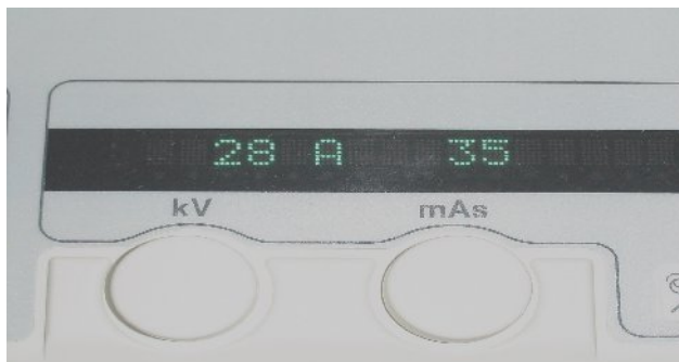
Figura 23 - Mesa de comando do mamógrafo onde se altera os valores mAs e kV
