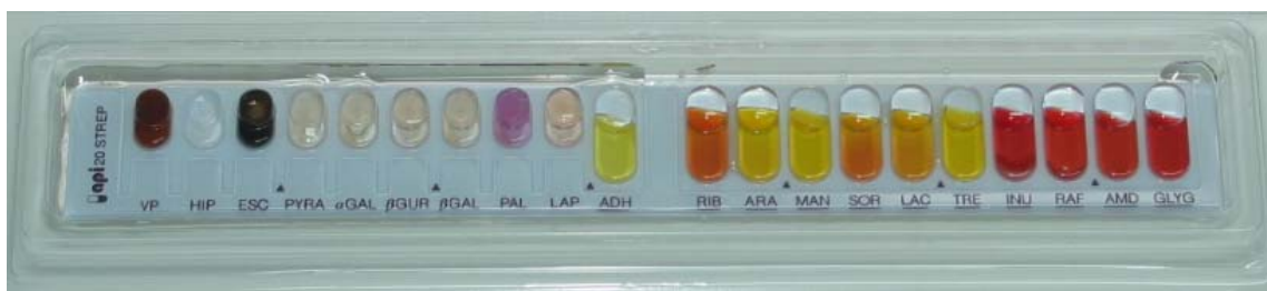
Figura 3.8 – Galeria API 20 Strep (bioMérieux Corporate) para identificação de bactérias do grupo enterococos, após incubação a (36.0 \pm 2.0)^\circ\text{C} durante 24h.
