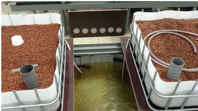
Figura 5 - Pormenor de um módulo usado no trabalho experimental, com o tanque para os peixes ao centro, posição inferior, e as duas camas de crescimento nas laterais, posição superior.
