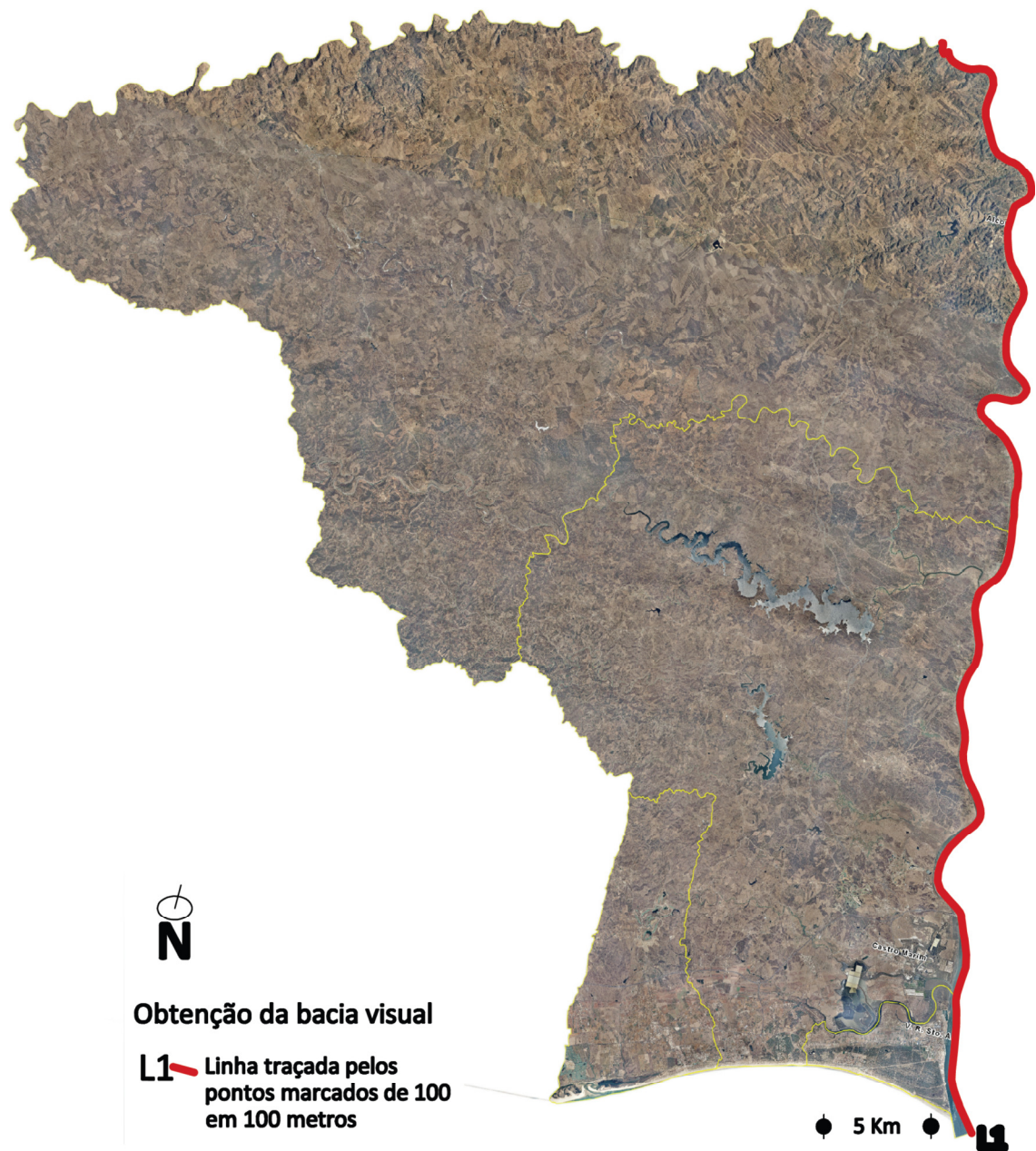
Figura 3.12 – Linha desenhada através da marcação de pontos para definir a bacia visual.
