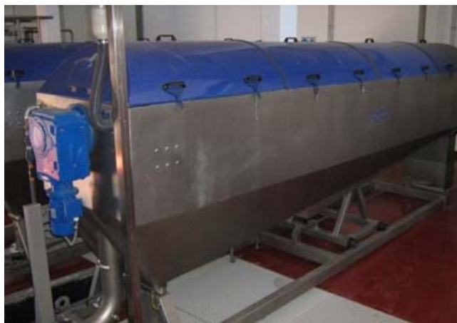
Figura 15 Tambores de espessamento
