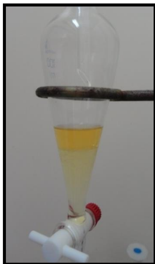
Figura 4.10 – Ensaio de extração líquido-líquido usando como agente de stripping a água do mar e as FO provenientes de outros ensaios de extração líquido-líquido. A fase que exibe a cor amarela representa a fase aquosa (menos densa, fica por cima) e a fase mais clara representa a fase orgânica (mais densa, fica em baixo).
