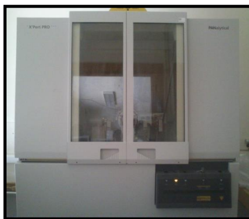
Figura 4.8 – Equipamento de Difração de raios-X (X'Pert Pro, PANalytical) utilizado no decorrer deste trabalho.
