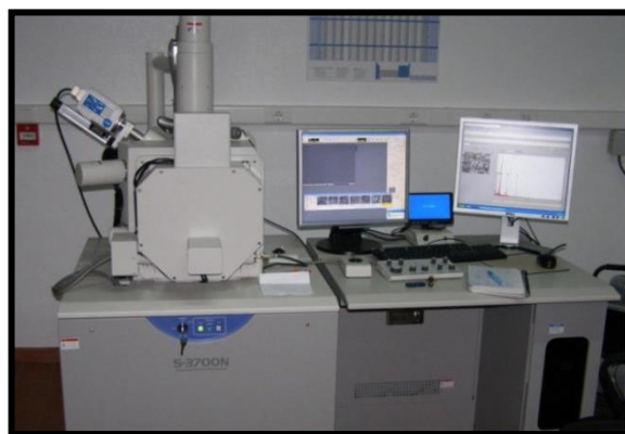
Figura 4.9 – SEM-EDS (Hitachi 3700N; Bruker Xflash 5010) utilizado para análise dos precipitados obtidos neste trabalho.
