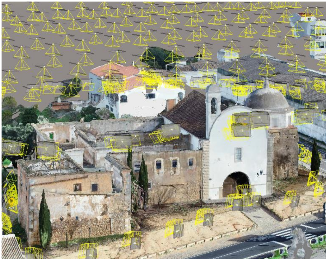
Figura 3 - Fotogrametria estereoscópica tiradas por drone, e fotogrametria convergente ao nível do solo. (foto do autor)
