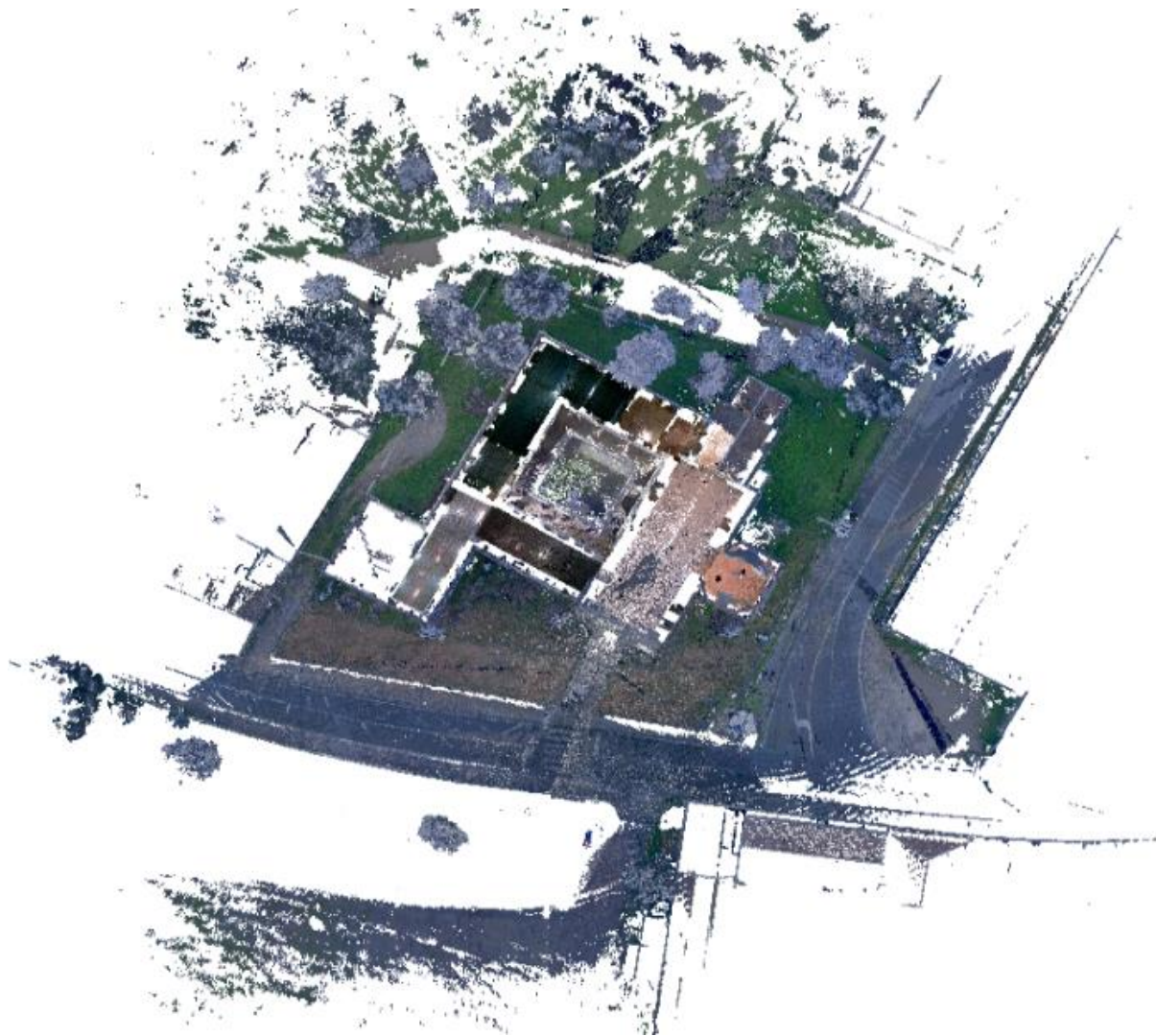
Figura 10 - Nuvem de pontos em bruto. Note-se os objetos medidos além do convento. (foto do autor)
