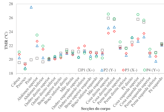
Figura 7.37- Distribuição a) da temperatura média radiante e b) da temperatura da pele em torno das secções do corpo de quatro indivíduos. Caso I de primavera/outono: T_{ext}= 18\text{ }^{\circ}\text{C} , T_i= 18\text{ }^{\circ}\text{C} , V_{ar}= 2\text{ m/s} .
