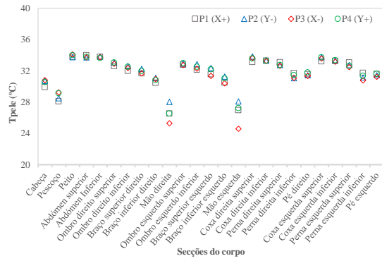
Figura 7.65- Distribuição da temperatura da pele em torno das secções do corpo de quatro indivíduos. a) sem chão radiante e b) com chão radiante. Caso II-A e II-B de inverno: T_{ext}= 8\text{ }^{\circ}\text{C} , T_i= 8\text{ }^{\circ}\text{C} , T_{ch}= 29\text{ }^{\circ}\text{C} , V_{ar}= 2\text{ m/s} .
