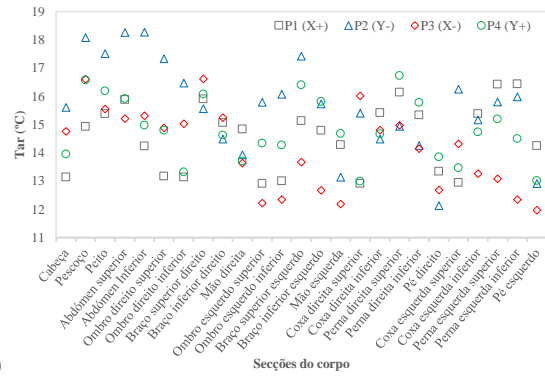
Figura 7.96- Distribuição a) da velocidade do ar e b) da temperatura do ar em torno das secções do corpo de quatro indivíduos. Caso III de inverno: T_{ext} = 8\text{ }^{\circ}\text{C} , T_i = 8\text{ }^{\circ}\text{C} , T_{par} = 50\text{ }^{\circ}\text{C} , V_{ar} = 2\text{ m/s} .
