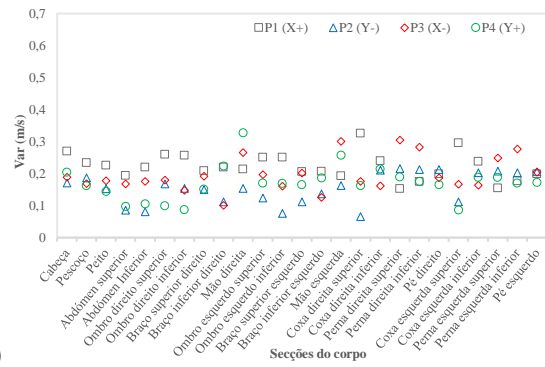
Figura 7.66- Distribuição da velocidade do ar em torno das secções do corpo de quatro indivíduos. a) sem chão radiante e b) com chão radiante. Caso II-A e II-B de primavera/outono: T_{ext}= 18\text{ }^{\circ}\text{C} , T_i= 18\text{ }^{\circ}\text{C} , T_{ch}= 29\text{ }^{\circ}\text{C} , V_{ar}= 1\text{ m/s} .
