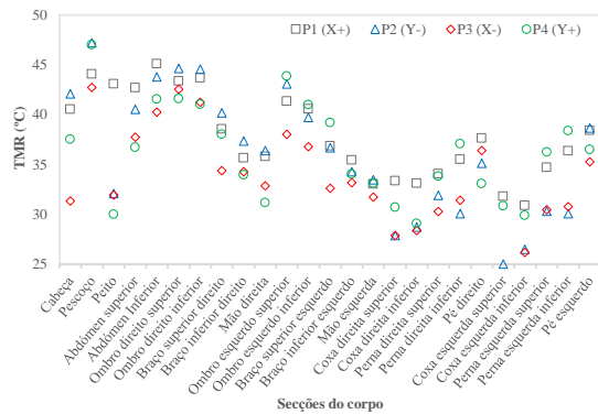
Figura 7.97- Distribuição a) da temperatura média radiante e b) da temperatura da pele em torno das secções do corpo de quatro indivíduos. Caso III de inverno: T_{ext} = 8\text{ }^{\circ}\text{C} , T_i = 8\text{ }^{\circ}\text{C} , T_{par} = 50\text{ }^{\circ}\text{C} , V_{ar} = 2\text{ m/s} .
