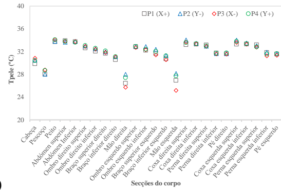
Figura 7.65- Distribuição da temperatura da pele em torno das secções do corpo de quatro indivíduos. a) sem chão radiante e b) com chão radiante. Caso II-A e II-B de inverno: T_{ext}= 8\text{ }^{\circ}\text{C} , T_i= 8\text{ }^{\circ}\text{C} , T_{ch}= 29\text{ }^{\circ}\text{C} , V_{ar}= 2\text{ m/s} .
