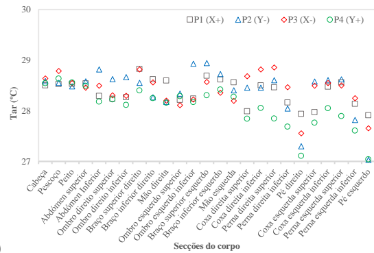
Figura 7.75- Distribuição da temperatura do ar em torno das secções do corpo de quatro indivíduos. a) sem chão radiante e b) com chão radiante. Caso II-A e II-B de verão: T_{ext} = 28\text{ }^{\circ}\text{C} , T_i = 28\text{ }^{\circ}\text{C} , T_{ch} = 19\text{ }^{\circ}\text{C} , V_{ar} = 1\text{ m/s} .
