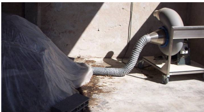
Figura 11 - Pilha preparada para compostagem (à esquerda: tubo de ventilação forçada, à direita: cobertura com tecido)
