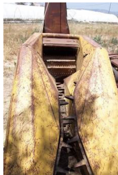
Figura 2 – Colhedor de milho (entrada do material e da zona de trituração)
