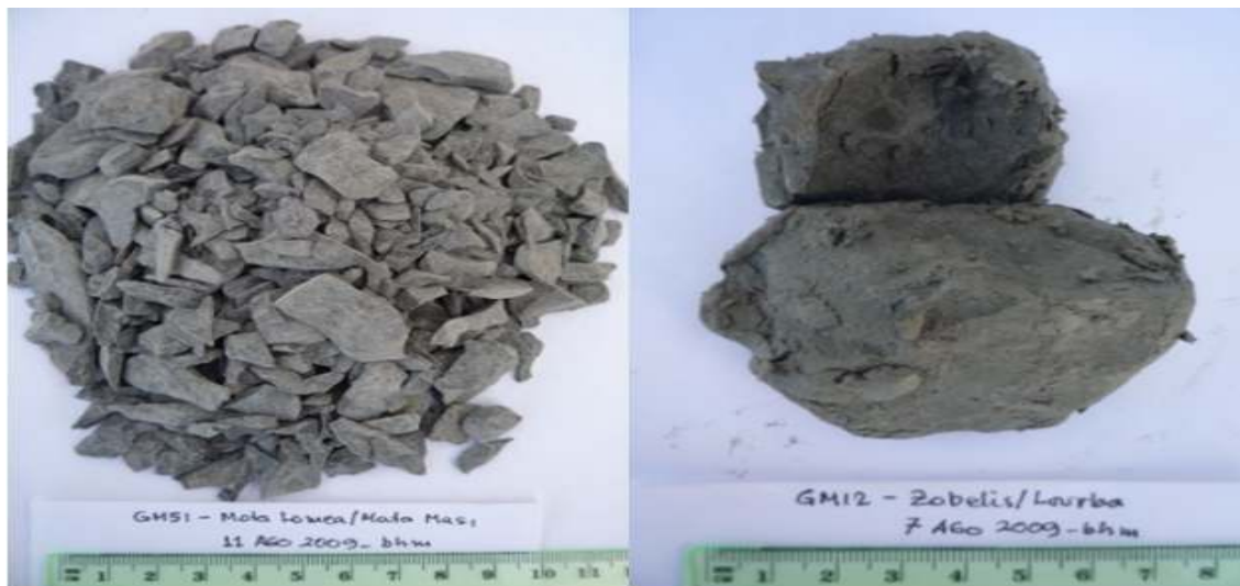
(a) (b) Figura 30 – Exemplos de amostras de xisto argiloso negro (a) - B2 (GM51) e (b) - B11 (GM12)
