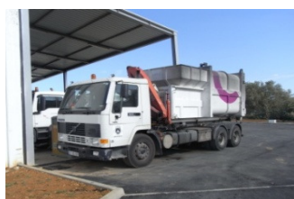
Figura II.2: Viatura de recolha e transporte de resíduos indiferenciados em contentores semi enterrados do tipo molok.
