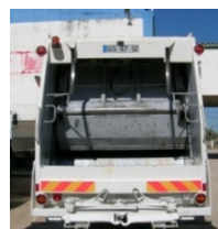
Figura II.1: Viatura de recolha e transporte de resíduos indiferenciados em contentores de superfície/enterrados de plataforma elevatória.
