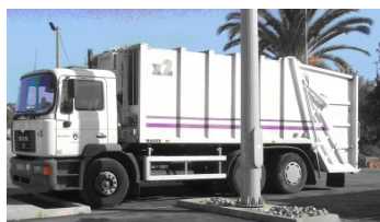
Figura II.1: Viatura de recolha e transporte de resíduos indiferenciados em contentores de superfície/enterrados de plataforma elevatória.
