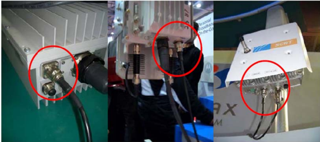
Figura 2.7 - Exemplos de Remote-radio heads com ligações de fibra óptica [16]
