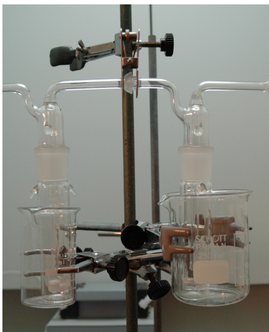
Figura 10: Os recipientes que contêm o reagente de cor foram colocados em copos de vidro onde será introduzido gelo durante o ensaio.
