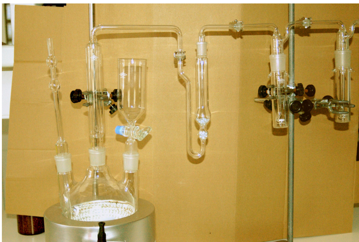
Figura 5: Aparelho em vidro para extracção, purificação e recolha do \text{CS}_2 produzido na hidrólise ácida dos ditiocarbamatos presentes na amostra.
