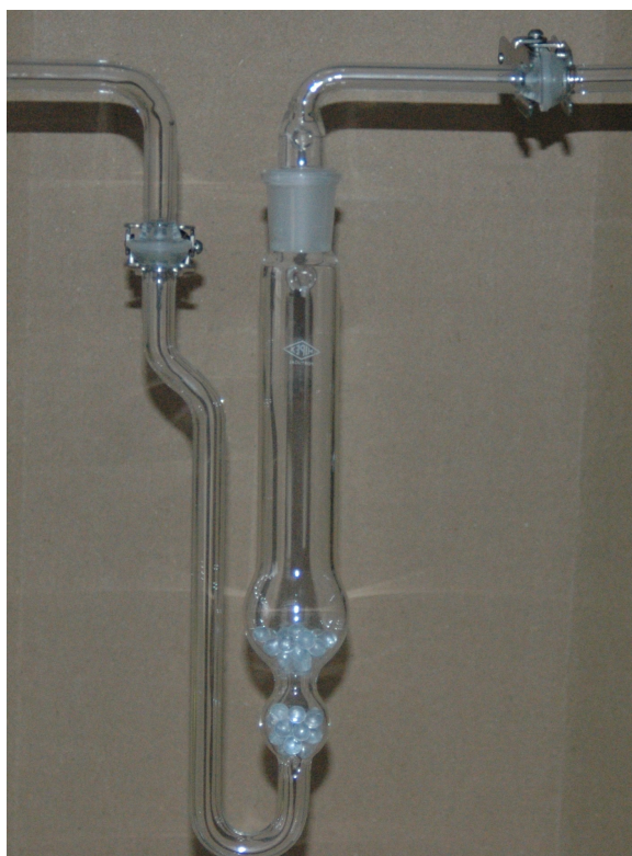
Figura 8: Peneiro químico, onde se encontra a solução de hidróxido de sódio.
