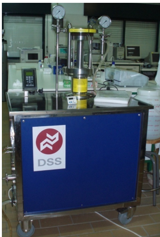
Figura 8. Instalação Lab-unit M20 da DSS utilizada nos ensaios
