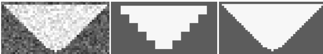
Fig. 4.10 – Ampliação do cone ( \sigma=25 ). Da esquerda para a direita a) imagem original; b) imagem etiquetas l=2 ; c) imagem etiquetas l=0 .
